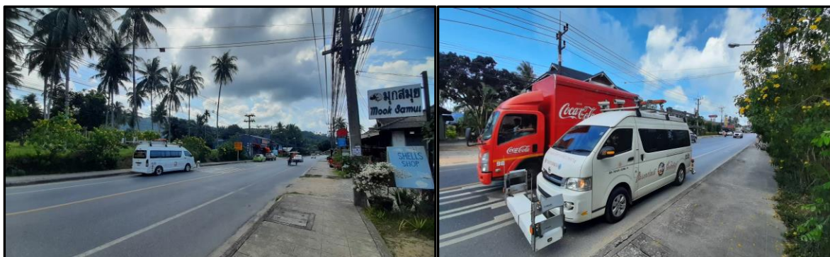
รูปที่ 7-1 การสำรวจค่า IRI (สำนักวิเคราะห์และตรวจสอบ)
