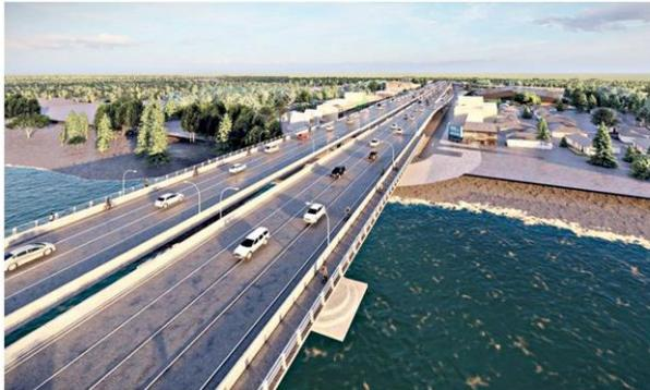
ออกแบบสะพานสิริลักษณ์ จาก 4 ช่องจราจรไป กลับเป็น 8 ช่องไปกลับ เพื่อเพิ่มประสิทธิภาพการจราจรและลดอุบัติเหตุ โดยก่อสร้างสะพานใหม่ ทดแทนทั้ง 2 สะพานขนาด 4 ช่องต่อทิศทาง
