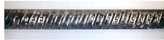
รูปที่ 4 เครื่องหมายการค้า ขนาดเส้นผ่านศูนย์กลาง และชั้นคุณภาพที่ประทับบนตัวเหล็กข้ออ้อย
