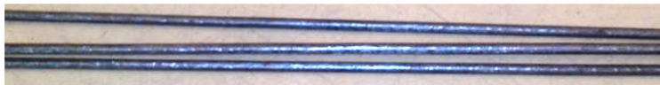
รูปที่ 5 ลวดเหล็กกล้าดึงเย็นเสริมคอนกรีต
