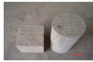
รูปที่ 1 การเขียนรายละเอียดลงบนผิวหน้าของแท่งคอนกรีตทรงลูกบาศก์และแท่งคอนกรีตทรงกระบอก
