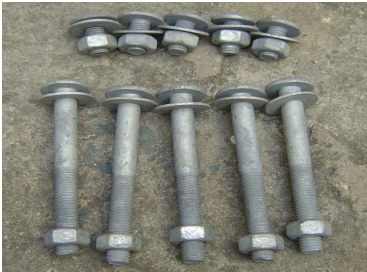
รูปที่ 10 ตัวอย่างสลักเกลียวยาว สลักเกลียวสั้น แป้นเกลียว แหวนรองที่ส่งทดสอบ
