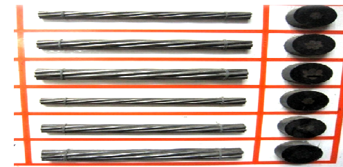
รูปที่ 9 ลวดเหล็กกล้าที่เกลียวสำหรับคอนกรีตอัดแรงแบบต่างๆ
