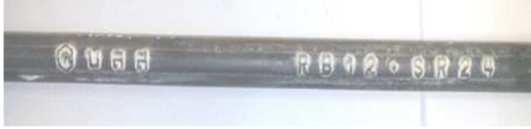
รูปที่ 3 เครื่องหมายการค้า ขนาดเส้นผ่านศูนย์กลาง และชั้นคุณภาพที่ประทับบนตัวเหล็กเส้นกลม
