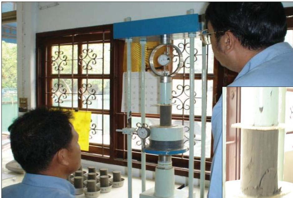
ภาพแสดงการทดสอบ Unconfined Compression Test
