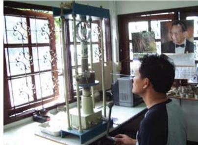
ภาพแสดงการทดสอบหาค่า Undrained Shear Strength
