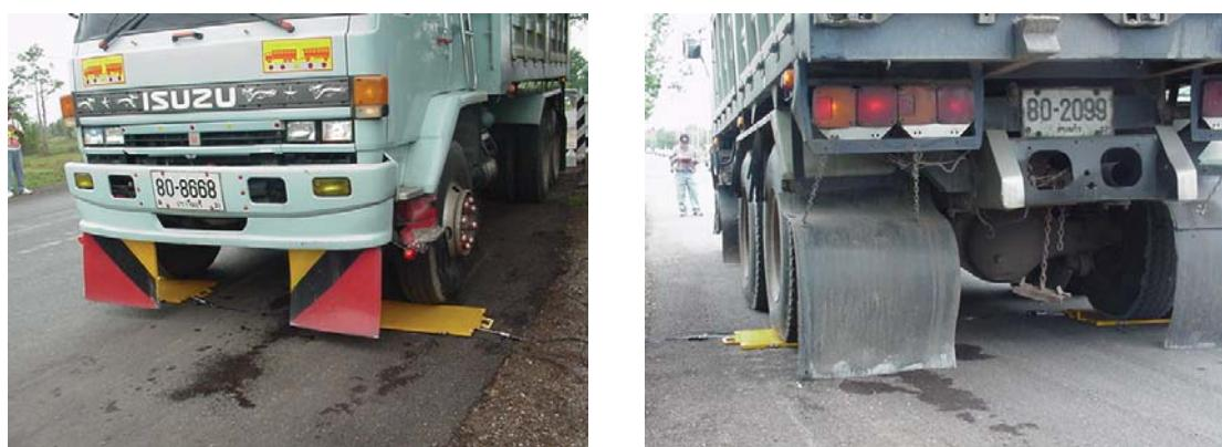
รูปที่ 8-9 การวัดน้ำหนักบรรทุกในแต่ละเพลา
