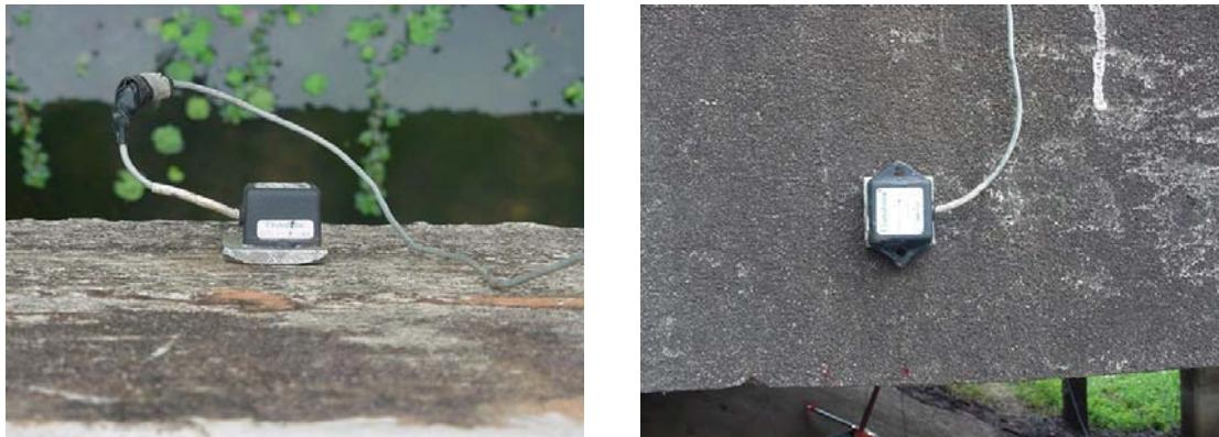
รูปที่ 8-13 ตัวอย่างการติดตั้งอุปกรณ์ตรวจวัดค่าความถี่ของโครงสร้าง
