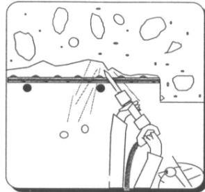
รูปที่ 5-11 แสดงการสกัดคอนกรีตแบบมีความลึกเพียงบางส่วน (Partial Depth)
