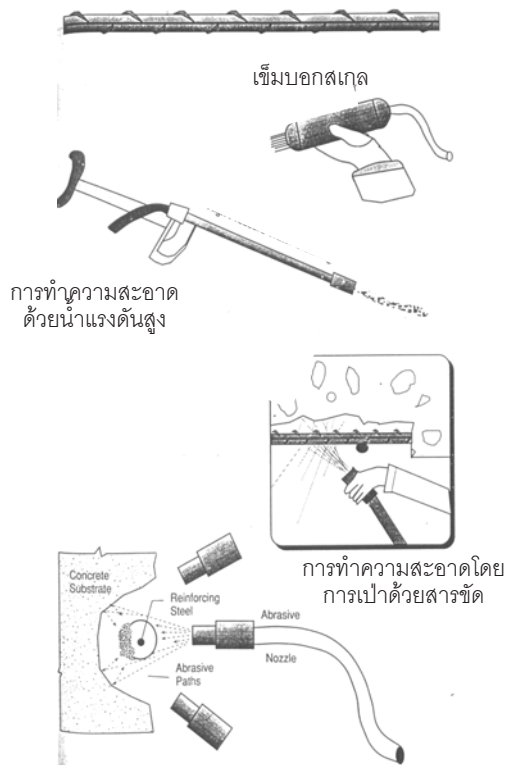
รูปที่ 5-14 แสดงวิธีการทำความสะอาดเหล็กเสริม
