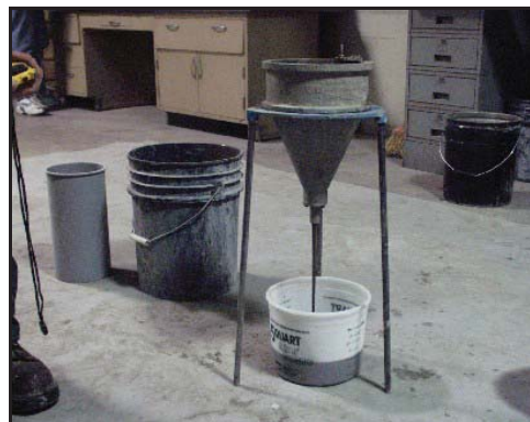
เครื่องมือทดสอบการไหล (แบบ Flow Cone) ใช้สำหรับทดสอบคุณสมบัติของคอนกรีต เพื่อใช้ในการงาน Subsealing
