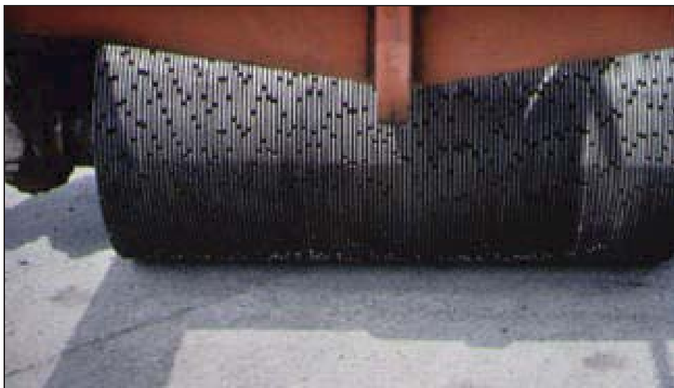
รูปที่ 3.3.3 การจัดใบมีดสำหรับขูดผิว
