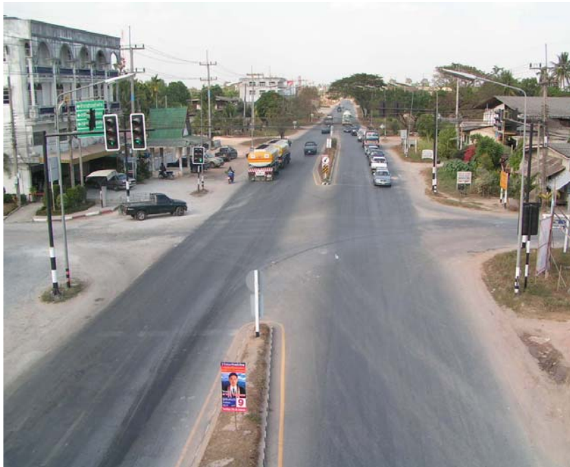
รูปที่ 1.15 การขาดการควบคุมจุดเข้าออกของทางสี่แยก
