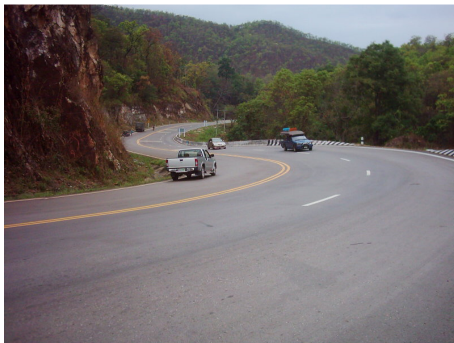
รูปที่ 4.9 การตีเส้นจราจรห้ามแซงบริเวณโค้ง
