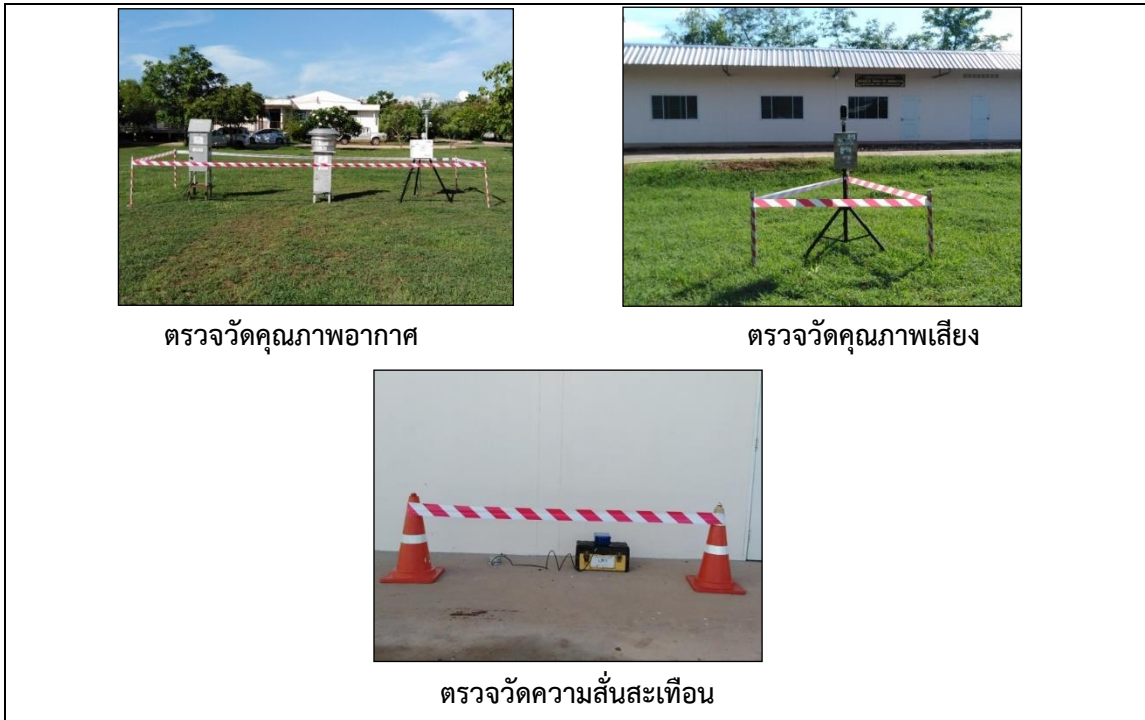
รูปที่ 4 การตรวจวัดคุณภาพสิ่งแวดล้อมบริเวณโรงพยาบาลกุสุมาลย์ บนทล.22 กม.186+783 (แพ็คเกจ K)
